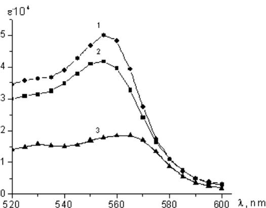
**Figure 1.** Absorption spectra of  $Zn(PAN)_2$  (1),  $Cd(PAN)_2$  (2),  $Mn(PAN)_2$  (3) complexes in the aqueous-micellar medium. Mass fraction of sodium ethoxydodecylsulphate  $\omega = 2,5 \%$ . Ion concentrations  $c(Zn(PAN)_2) = 0,1 \cdot 10^{-5} \text{ mol/l}$ ,  $c(Cd(PAN)_2) = 0,1 \cdot 10^{-5} \text{ mol/l}$ ,  $c(Mn(PAN)_2) = 0,1 \cdot 10^{-5} \text{ mol/l}$
