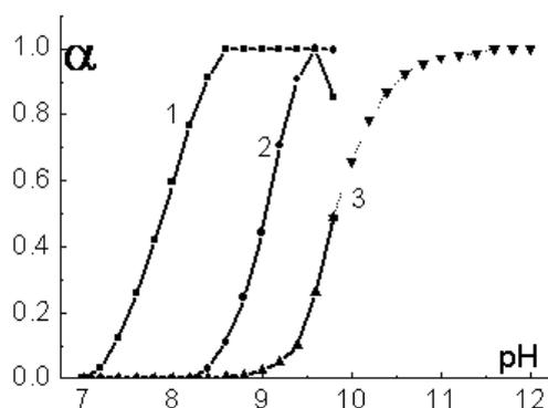
**Figure 2.** The yield of complexes - pH relationship in aqueous-micellar medium  $Zn(PAN)_2$  (1),  $Cd(PAN)_2$  (2),  $Mn(PAN)_2$  (3).  $\omega$ (sodium ethoxydodecylsulphate) = 2,5 %. Ion concentrations  $c(Zn(PAN)_2) = 0,1 \cdot 10^{-5} \text{ mol/l}$ ,  $c(Cd(PAN)_2) = 0,1 \cdot 10^{-5} \text{ mol/l}$ ,  $c(Mn(PAN)_2) = 0,1 \cdot 10^{-5} \text{ mol/l}$
